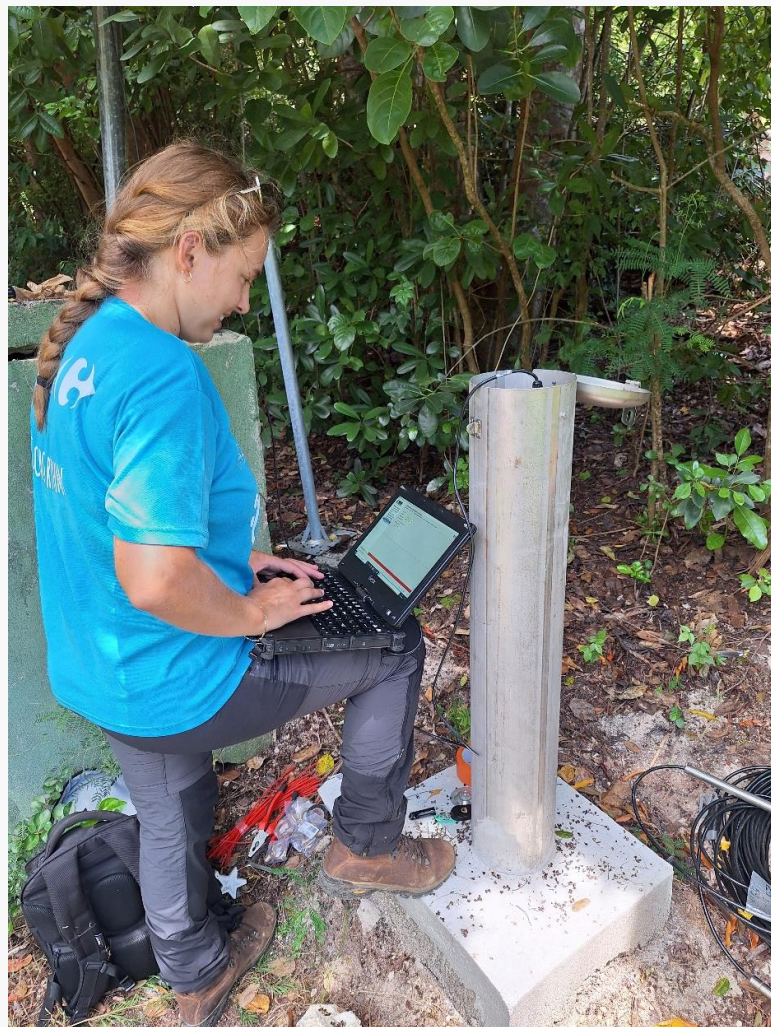
Mesures de terrain – Piézomètre de Coulisse (@BRGM)
