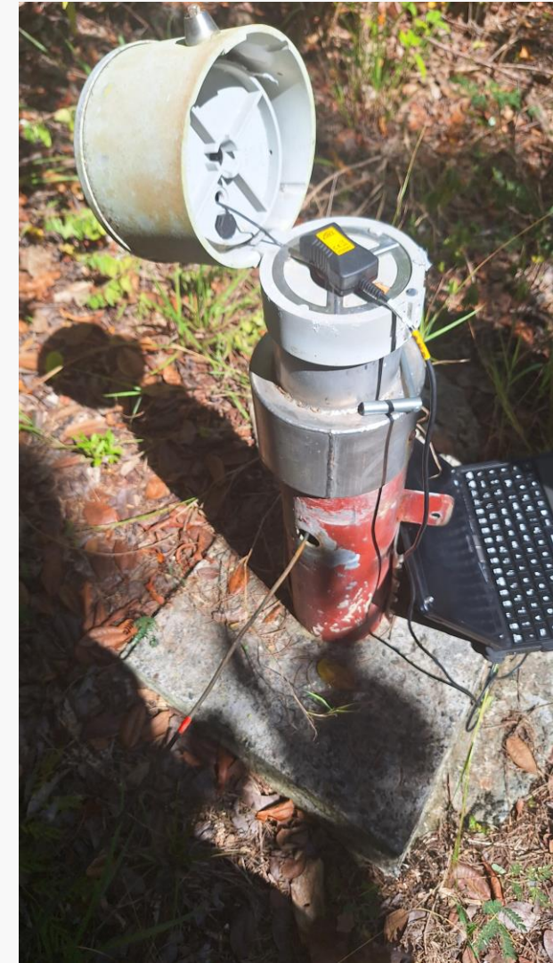
Déchargement des données de terrain – sonde OTT (@BRGM)
