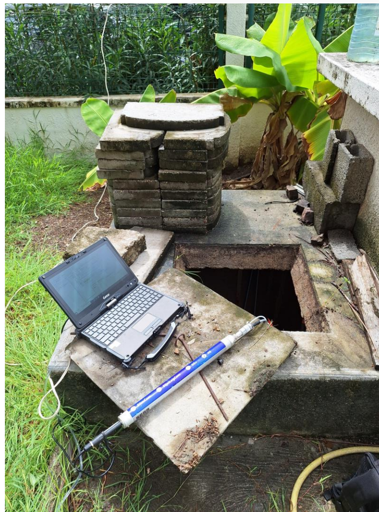
Déchargement des données de terrain – sonde SEBA (@BRGM)
